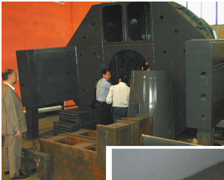
Figura 2b: In alto, componenti meccanici del VST: l' azimuth box in lavorazione, alla fine del 2001, presso la ditta De Juliis (SA) e, sotto, il base plate già collocato nell'area di montaggio del telescopio, presso la ditta Mecsud di Scafati. In basso, l'opera in cemento dell'edificio di VST, in realizzazione a Paranal nel gennaio 2002 (indicato da una freccia rossa nell'immagine della vetta di Cerro Paranal, tra le unità UT3 e UT4 del VLT).
