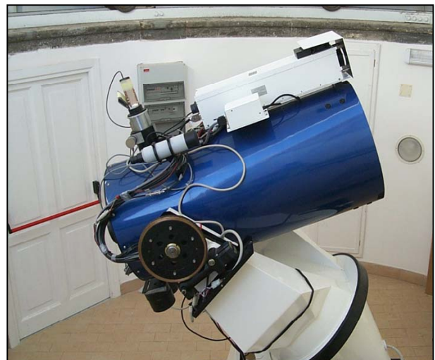
Figura 6: Lo strumento VAMOS sul telescopio da 40 cm sito nella cupola Est dell'OAC.
