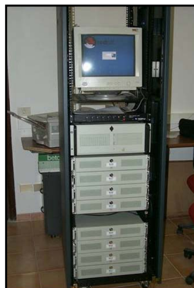
Figura 10: Prototipo OAC di un cluster Beowulf a 8 nodi.
